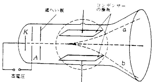
ガラス容器に陰極  $K$ 、陽極  $A$ 、遮蔽板およびコンデンサーの極板がハンダ付けされている。 $K$  と  $A$  の間には、陰極線を出すのに十分な高い電圧がかけられている。陽極と遮蔽板とに開けられた〈スリット〉が陰極線の細いビームを〈切り取り〉、そのビームは容器の反対側の壁に当たって、そのガラスを発光させる。図中の丸い点線はコイル(容器の外側にある)を示し、それがコンデンサーの電場(および紙面)に垂直な磁場を発生する。
